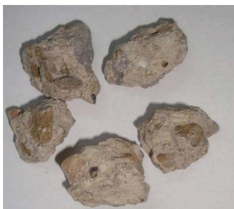
Figura 3.7. Agregat reciclat de beton (10-20 mm)
