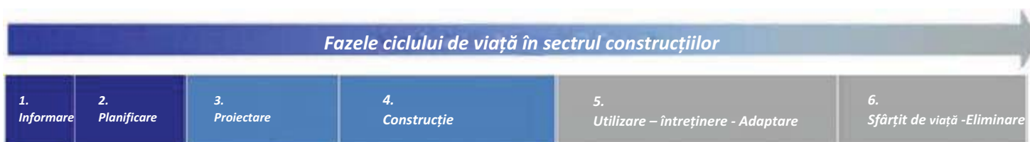
Figura 4.10. Etapele ciclului de viață în sectorul construcțiilor- Sursa: Project Sustainability Assessment, Franco Angeli, Fregonara E., 2015, p. 27.
