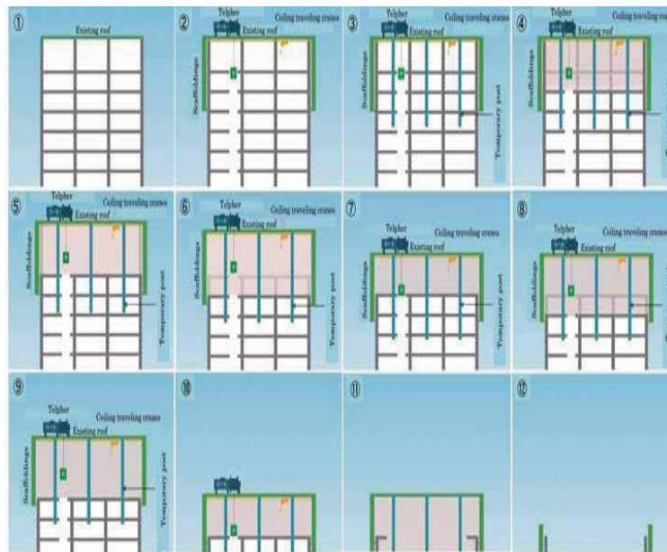
Figura 3.15. Procedul de demolare TECOREP (Sursa:Taisei Corporation)
